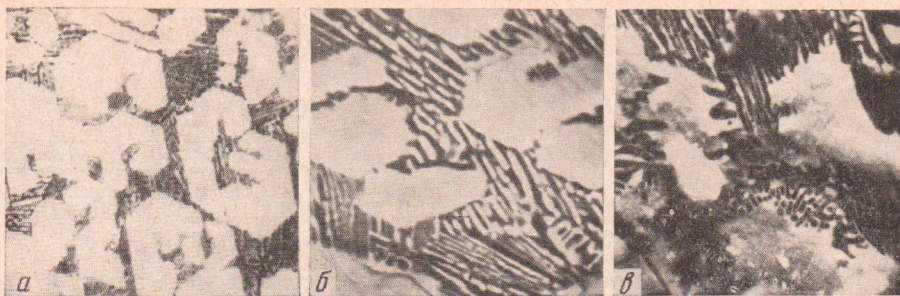
Рис. 1. Микрофотографии заэвтектического сплава, полученные: а — на оптическом микроскопе (1000 \times ); б, в — на растровом электронном микроскопе «Стереоскан», с участками эвтектики \text{Fe}_3\text{C} — \text{Fe}_7\text{C}_3 с пластинчатым (б — 2400 \times ) и сотовидным строением (в — 2100 \times )
