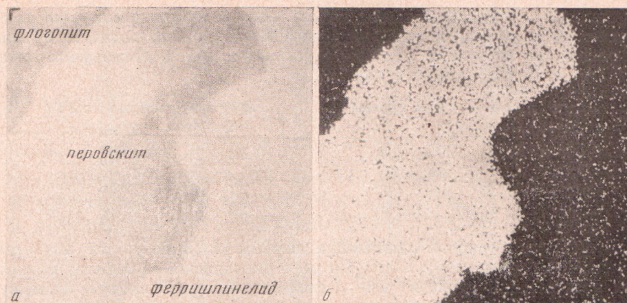
Рис. 3. Кайма перовскита у ферримангнитного минерала. а — изображение в поглощенных электронах, б — изображение в рентгеновских лучах TiK_{\alpha} . 600 \times
