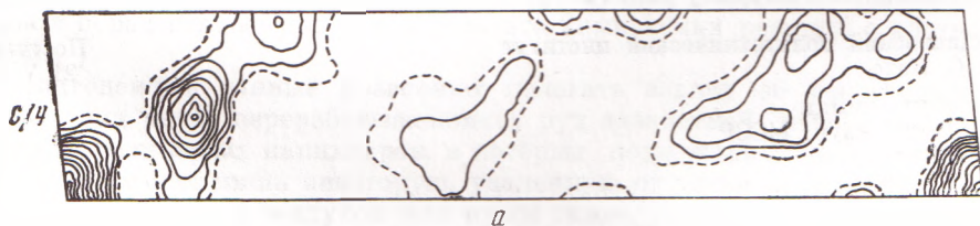
Рис. 3. Проекция 1/4 ячейки пространства межатомных векторов на плоскость (xy)
