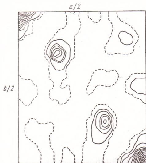
Рис. 4. Проекция 1/4 ячейки пространства межатомных векторов на плоскость (xz)
