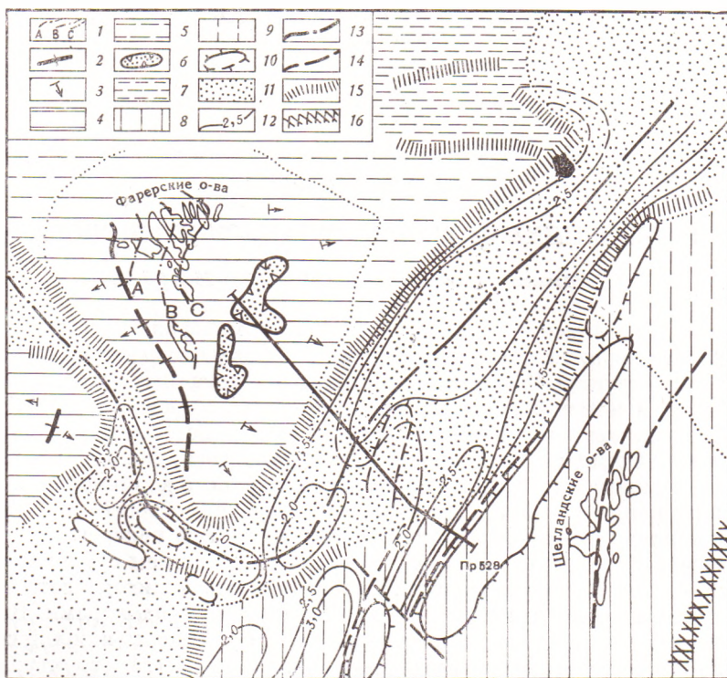
Рис. 1. Структурно-тектоническая схема Фареро-Шетландского района. Фарерские острова: 1 — оси простирации вулканических серий А, В, С плато-базальтов; 2 — ось главной антиклинали островов; 3 — направление падений пластов на подводном плато по сейсмическим данным; 4 — развитие плато-базальтов непосредственно под дном моря; 5 — развитие плато-базальтов, перекрытых малоомощным чехлом осадков; 6 — наложенные впадины, заполненные осадками; 7 — северный аккумулятивно-разломный склон островов. Шетландские острова: 8 — участки выходов под дно докембрийских и нижнепалеозойских отложений; 9 — участки развития каледонид, перекрытых мезозойскими отложениями; 10 — положительные структурные формы (антиклинальные перегибы, поднятия) в низах осадочного чехла и в фундаменте. Фареро-Шетландский желоб: 11 — развитие осадочной толщи в пределах желоба; 12 — изопахиты осадочной толщи в км; 13 — ось желоба; 14 — разломы в осадочном чехле и разломы, выходящие на поверхность; 15 — разломы в фундаменте; 16 — предполагаемое трассирование разлома Грейт-Глен
