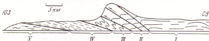
Рис. 2. Разрез в районе Порей губы. I — зона горизонтальных структур; II — зона разрывных нарушений; III — зона изоклиальной складчатости; IV — зона развития моноклиальной сланцеватости; V — сложно-складчатый комплекс беломорид
