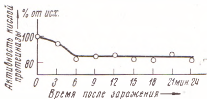
Рис. 3. Изменение активности кислой протеиназы клетки-хозяина после заражения бактериофагом. Ферментативная реакция в 0,5 М К, Na-фосфатном буфере, pH 5,7
