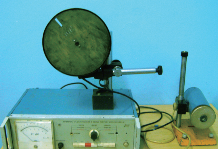
图 2.1 IMO-2H 激光辐射平均功率和能量脉冲的测量仪
