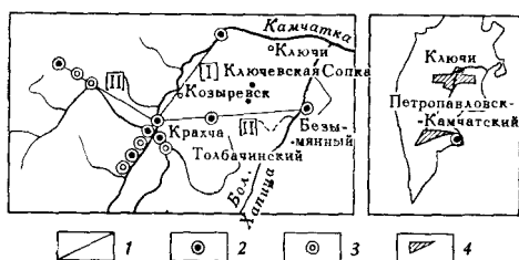
Рис. 1. Схема расположения профилей ГСЗ на Камчатке. 1 — профили ГСЗ; 2 — пункты взрыва стационарные; 3 — пункты взрыва временные; 4 — районы работ
