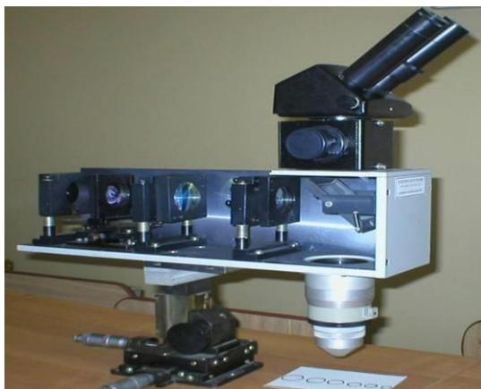
Рисунок 3 – Оптическая приставка для формирования пучков кольцевого сечения
