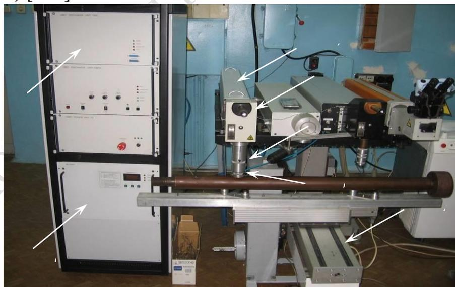
1 – блок питания лазера; 2 – излучатель; 3 – система визуального наблюдения; 4 – координатная система; 5 – фокусирующий объектив; 6 – блок охлаждения; 7 – система подачи газовой среды
