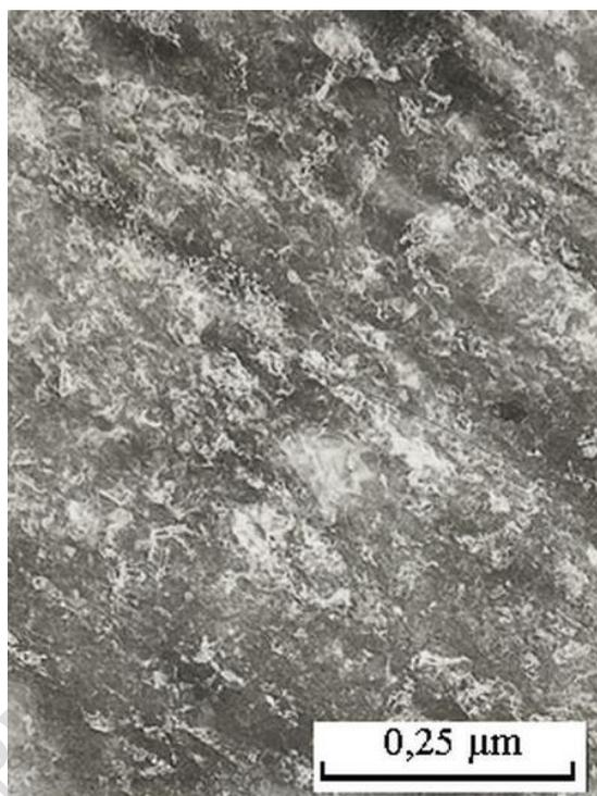
Рисунок 1 – Наноструктура никеля
