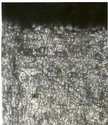
Рисунок 5 – Структура хромового покрытия ( $\times 1000$ )
