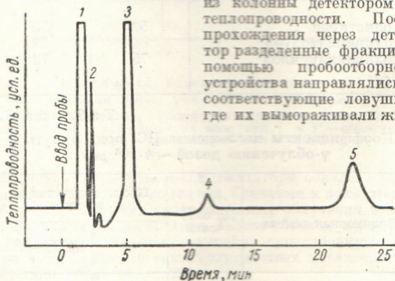
Рис. 1. Хроматограмма исходной смеси метилэтоксисиланов на аналитическом хроматографе: 1 — эфир; 2 — триметилэтоксисилан; 3 — диметилдиэтоксисилан; 4 — метилтриэтоксисилан; 5 — тетраэтоксисилан.
