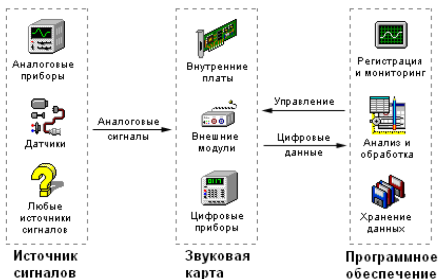
Рисунок 1 – Блок-схема измерительной системы, построенной на базе персонального компьютера
