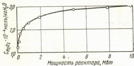
Рис. 5. Зависимость концентрации растворенной в воде первого контура перекиси водорода от мощности реактора:
