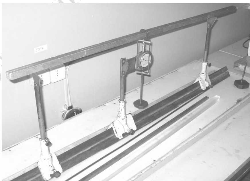
Рисунок 1.4 – Установка для определения модуля Юнга
