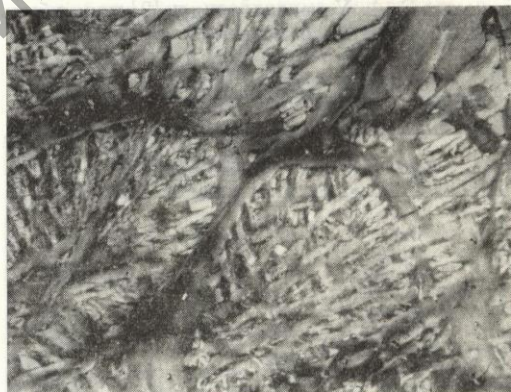
Рис. 5. Почковидный микроагрегат настурана II, расчлененный антрацитом на растянутые обломки. Между почками настурана (размер их не более 1 мкм) имеется кайма антрацита почти без обломков настурана. Антрацит резко анизотропен. Полированный шлиф, николи + ( \times 100 ).
