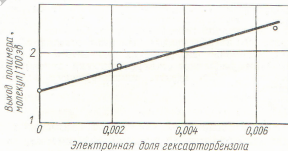
Р и с. 3. Зависимость выхода высококипящих продуктов радиолиза от электронной доли при концентрациях гексафторбензола 0—0,05 М.
