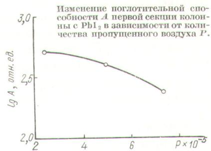
Изменение поглотительной способности  $A$  первой секции колонны с  $PbI_2$  в зависимости от количества пропущенного воздуха  $P$ .
