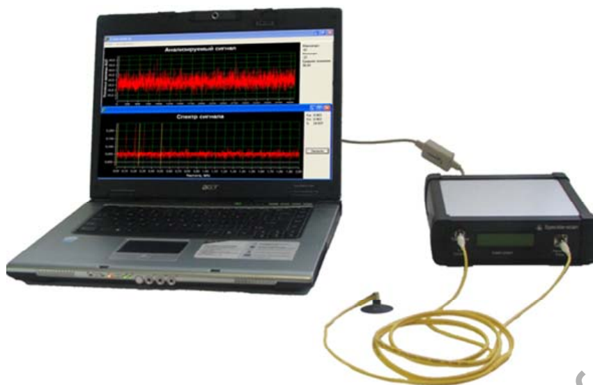
Рисунок 1 – Экспериментальный образец лазерной спекл-оптической системы контроля микроциркуляции крови «Speckle-Scan»
