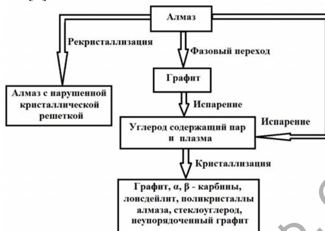
Рисунок 1 – Схема фазовых превращений алмаза под воздействием лазерного излучения
