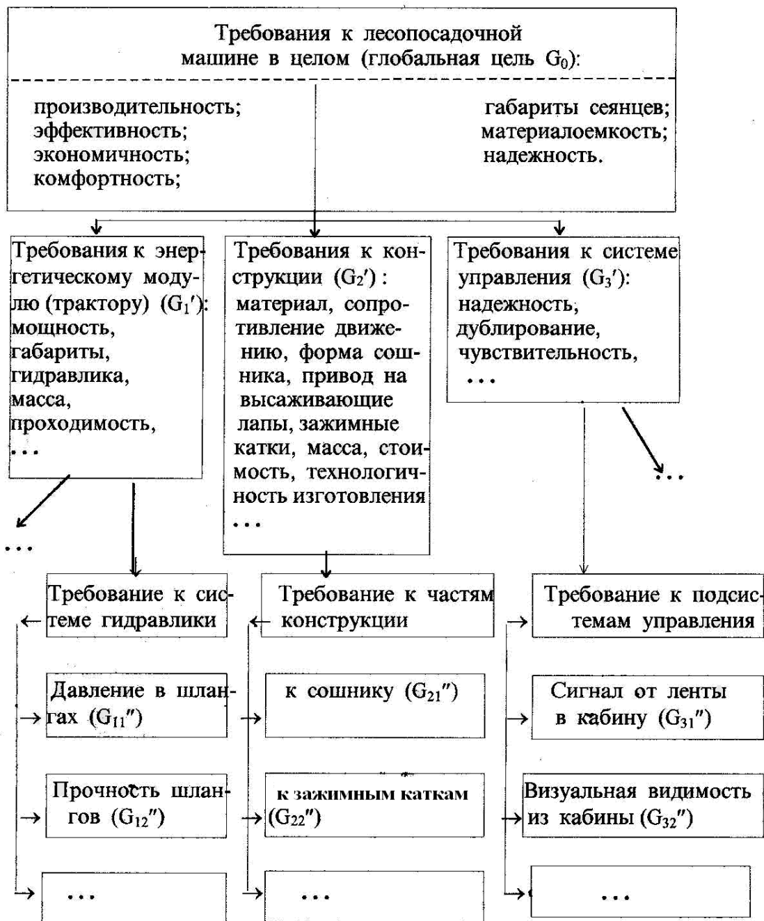
Рисунок 2.6 – Схема конструирования лесопосадочной машины
