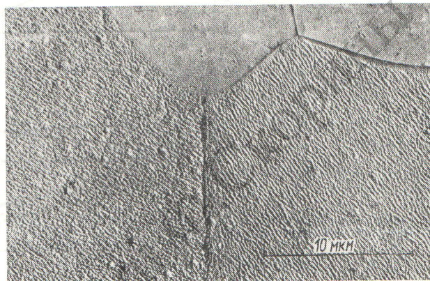
Р и с. 1. Электронно-микроскопический снимок реплики с поверхности ниобия после распыления
