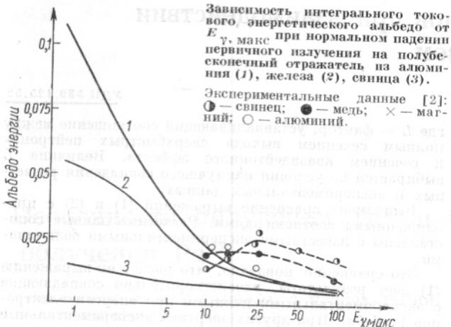
Зависимость энергетического альбеда от  $E_{\gamma, \max}$  представлена на рисунке. Для  $E_{\gamma, \max} = 3 \div 100 \text{ МэВ}$  эта зависимость с достаточно хорошим приближением описывается формулой
