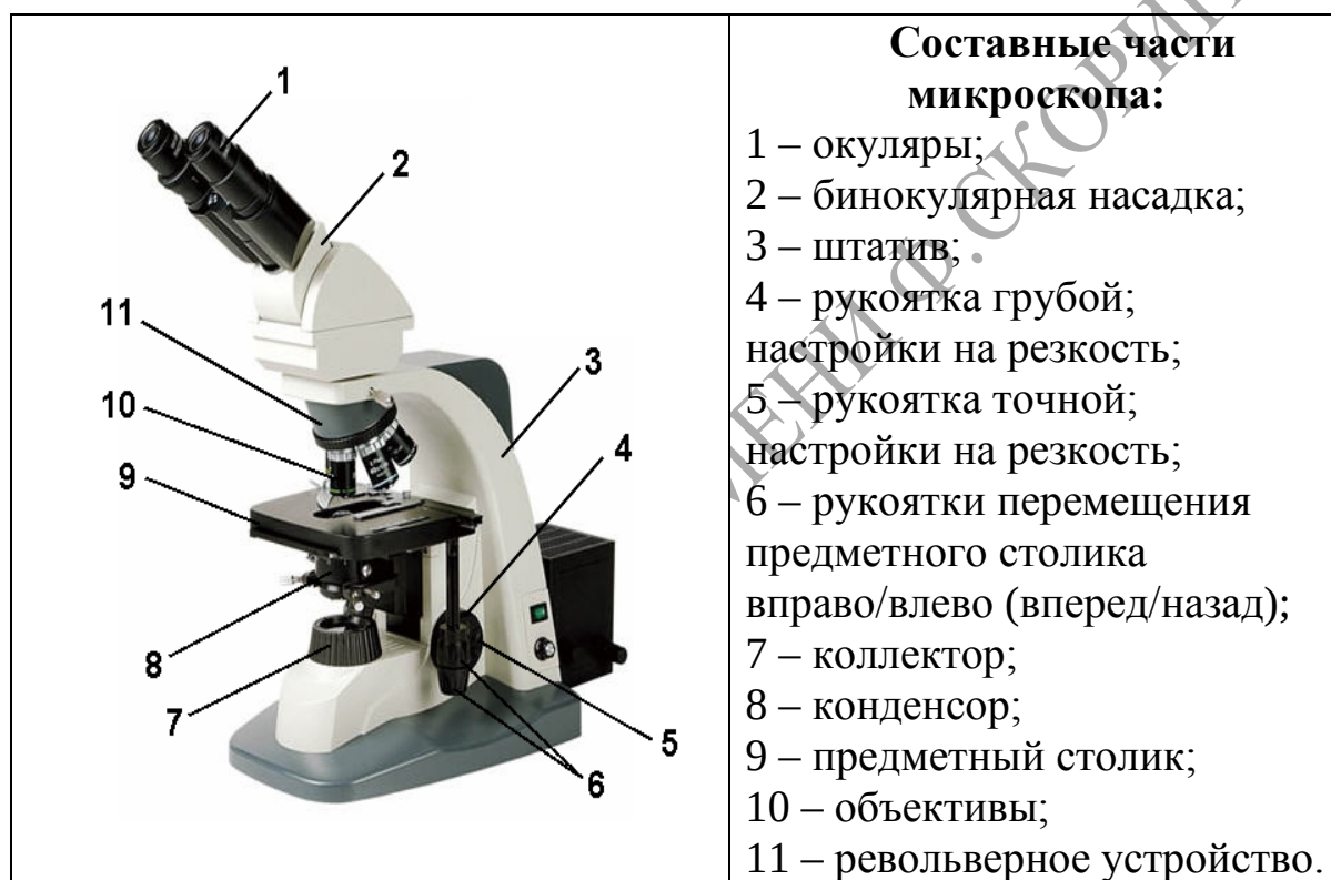
Рисунок 3.1 – Устройство и внешний вид микроскопа
