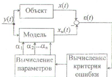
Рисунок 8.1 — Структурная схема системы для определения динамических характеристик объекта компенсационным методом
