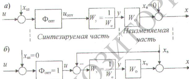
Рисунок 8.2 — Алгоритмические структуры идеальной разомкнутой системы
