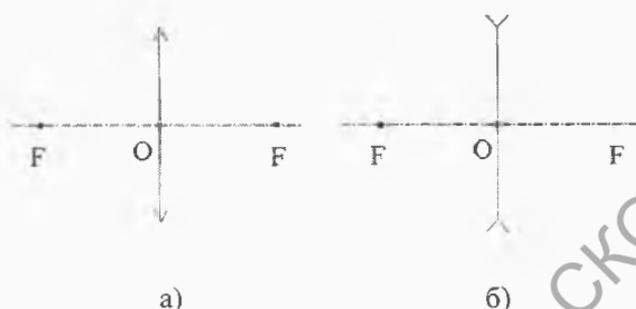
Рисунок 2.4 – Схематическое изображение собирающей (а) и рассеивающей (б) тонких линз
