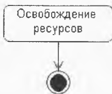
Рисунок 1.4 – Переход в конечное состояние
