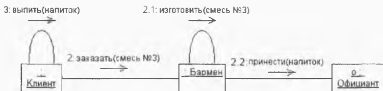
Рисунок 3.2 – Поток синхронных сообщений
