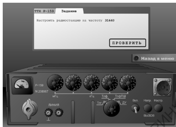
Рисунок 2 – Задание для настройки радиостанции P-159
