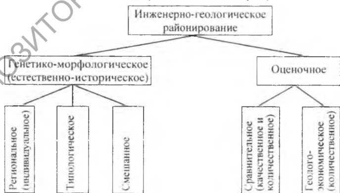
Рисунок 1 – Систематика типов инженерно-геологического районирования (по В. Т. Трофимову)
