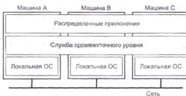
Рисунок 1 – Распределенная система организована в виде службы промежуточного уровня
