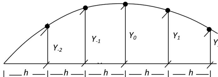
$Y_i$  – отклонения положения трубопровода от проектного, полученные из нивелирования, на деформационных марках, закреплённых на трубе
