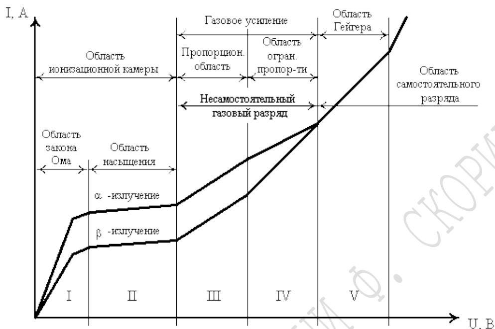
Рисунок 2 – Зависимость электрического тока в газе от напряжения на электродах камеры (ВАХ)
