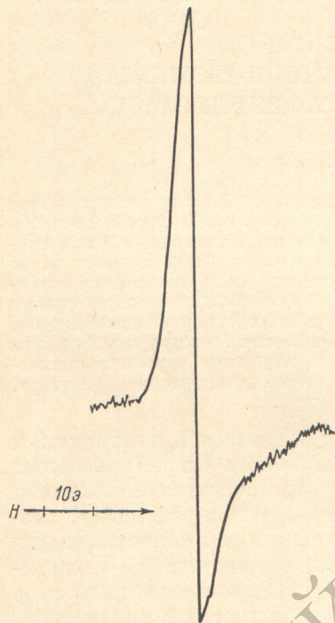
Рис. 1. Спектр ЭПР раствора Zn-ТФП в ДМФА в присутствии Ну после облучения видимым светом (облучение производилось при -60^\circ С, измерение спектра — при 77^\circ К).
