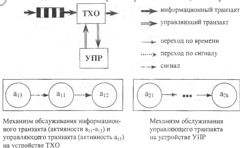
Рис. 2. Схема взаимодействия информационного и управляющих транзактов с возвратом последнего на обслуживающее устройство ТХО
