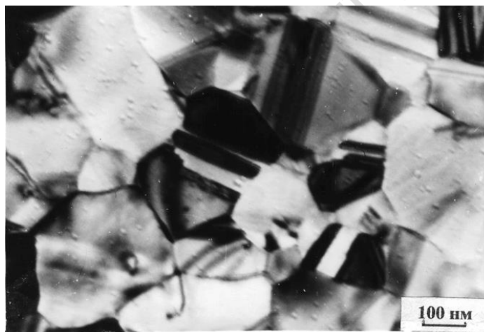
Рисунок 1 – Структура пленки никеля после лазерной обработки, длительность импульса 10^{-3} с, плотность мощности 3,6 \cdot 10^4 Вт/см 2 .
