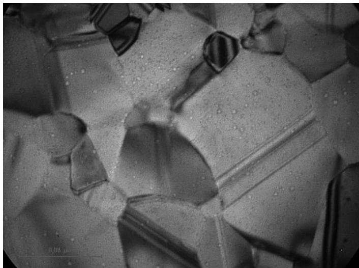
Рисунок 2 – Структура пленки никеля после лазерной обработки, длительность импульса 30 нс, плотность мощности 6.5 \cdot 10^6 Вт/см 2 .
