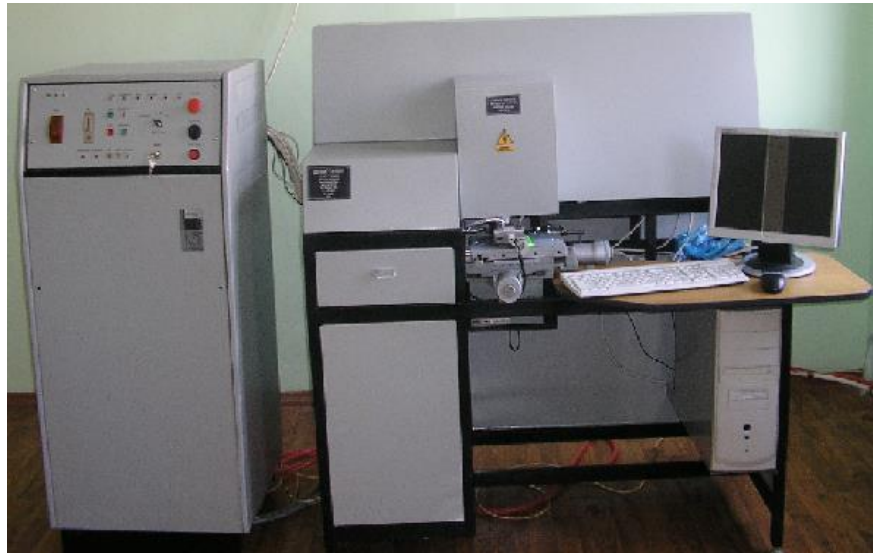
Рисунок 2 – Общий вид установки для лазерной маркировки монокристаллов СТМ M1617.00.00.000
