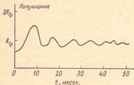
Рис. 1. Изменение полуширины светящегося шнура во времени.
