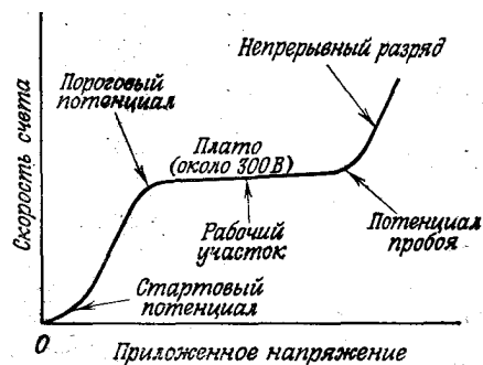
Рис. 7.3. Режим работы счетчика Гейгера-Мюллера
