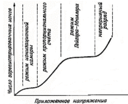
Рис. 7.2 Влияние приложенного напряжения на поток ионов
