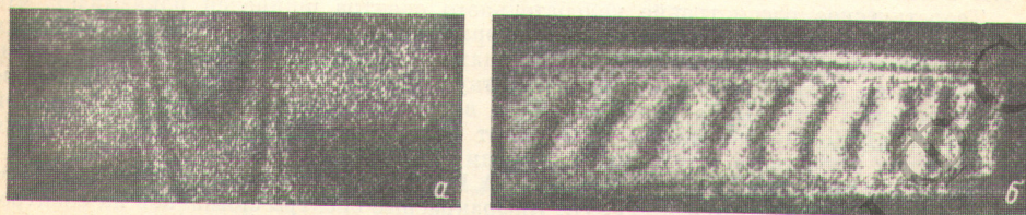
Рис. 2. Интерферограмма сдвига куска мела (а) и интерферограмма сравнения двух различных кусков мела (б).
