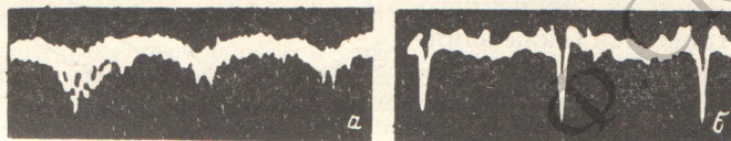
Рис. 2. Осциллограммы зависимости W(H) для одночастотного лазера с пластинкой Брюстера в резонаторе (а) и с почти изотропным резонатором (б).
