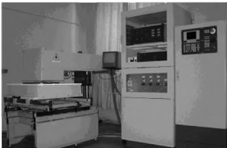
Рис. 1. Лазерный технологический комплекс YAG-ЛАЗЕР
