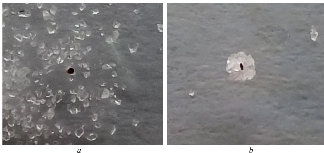
Рис. 10. Частица примеси в сырье: a – до обработки; b – после обработки
