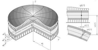
Рисунок 1 – Расчетная схема трехслойной пластины
