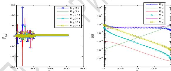
Рисунок – Динамика сходимости амплитуд выходных полей итерационного метода (3) и решение задачи (1) для случая трех встречных сигналов  $E_2, E_4, E_6$  в поле попутных и встречной накачек  $E_1, E_3, E_5$  (справа).
