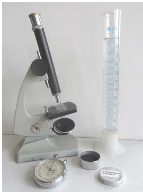
Рисунок 2.3 – Установка для определения вязкости методом Стокса
