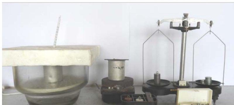
Рисунок 5.1 – Установка для определения удельной теплоёмкости твердых тел
