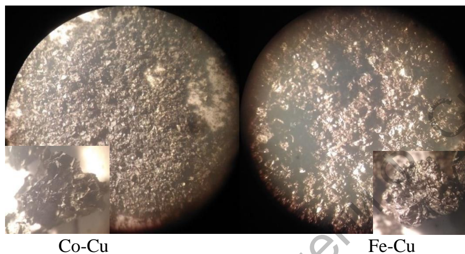
Рисунок 1 – Вид структуры порошков на основе оксидов Co-Cu и Fe-Cu
