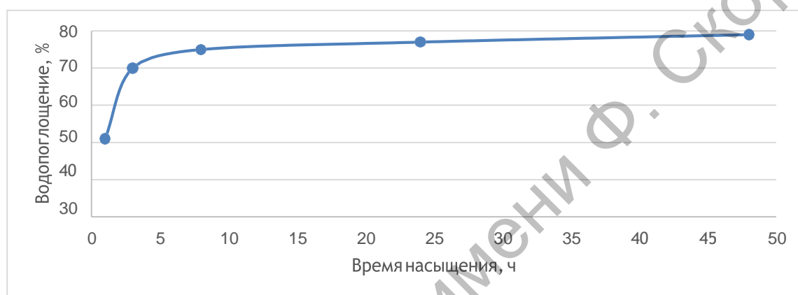
Рисунок 1 – Зависимость водопоглощения в негидрофобизированном образце минераловатных теплоизоляционных плит «Фасад 12» производства «Белтеп»
