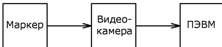
Рисунок 1 – Структурная схема системы видеорегистрации тремора
