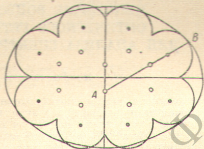
Рис. 3. Изображение молекулы нафталина в виде эллипсоида с диаметрами: l_1=10.2 , l_2=7.4 , l_3=3.4 Å.
