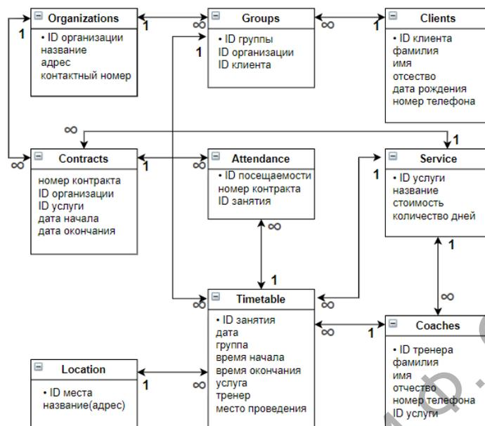
Рисунок 1 – База данных разрабатываемого программного продукта
