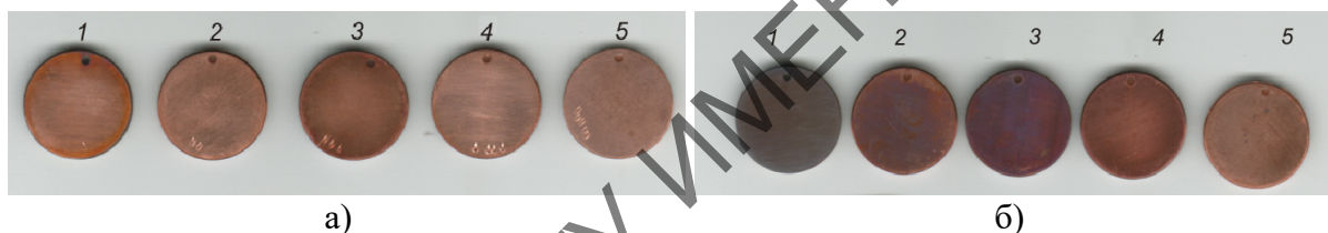
Рисунок 3 – Общий вид медных образцов после 8 часов выдержки в нагретом до 60° С масле: а – сразу после испытаний; б – после выдержки на воздухе в течение 12 часов. Выдержка в маслах: 1 – И-20А; 2 – льняное; 3 – рапсовое; 4 – подсолнечное; 5 – кукурузное
