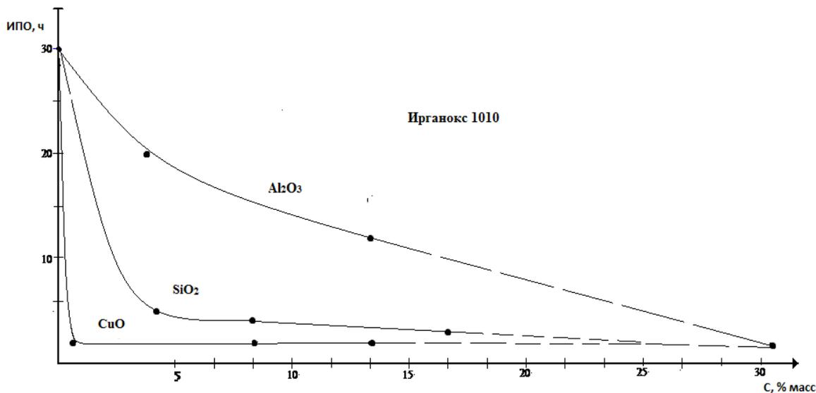
Рисунок 2 – Зависимость продолжительности ИПО (ч) полиэтиленовых пленок толщиной 100 мкм, содержащих 0,1 % масс. ирганокса 1010, от концентрации С (%) наполнителей: оксида алюминия, оксида кремния и оксида меди. Температура окисления 150 °С
